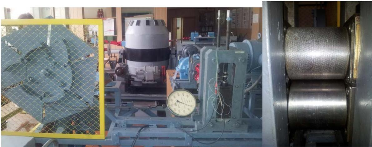
Рис. 2. Прокатка полосы натяжением в холостых валках
